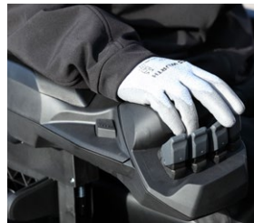
Vingertipbedieningen hydraulica (optioneel)
